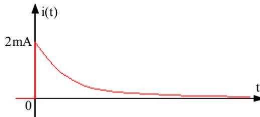
Conoscendo l'andamento della corrente posso sfruttare la relazione di Ohm per il resistore ed ottenere l'andamento della tensione sul resistore che, come si nota, equivale alla tensione che si misura tra il nodo A ed il nodo di massa; si ricava così:
