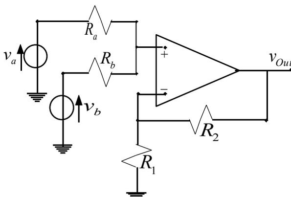
Anche in questo caso si procede con il metodo della sovrapposizione degli effetti; spegnendo dunque il generatore b si ottiene che la tensione in ingresso è quella ottenuta da un partitore di tensione relativo alle due resistenze di ingresso con il quale si esplicita la tensione sul resistore b; in questa situazione l'uscita sarà dunque la seguente:
