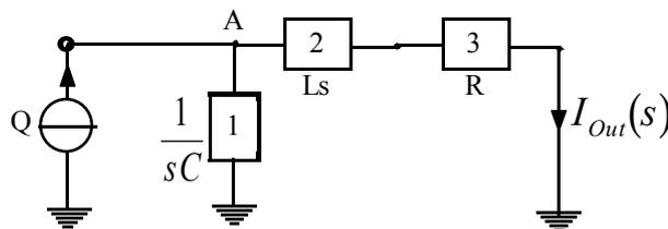
Notiamo dunque che, per ricavare la corrente in uscita, sarà sufficiente applicare la regola del partitore di corrente al nodo A, ottenendo:
