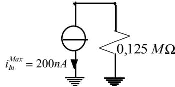
Il segnale deve essere processato in modo da entrare in un ADC (Analog to Digital Converter) che legge tensioni dell'ordine dei 5V. Realizzare il circuito che permette il processamento richiesto.
