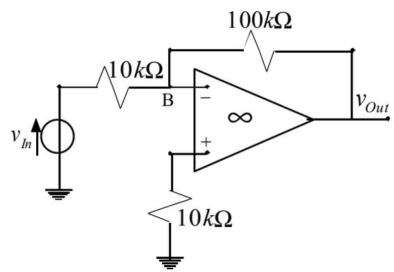
Ancora una volta il guadagno dell'amplificatore non viene modificato perché nella nuova resistenza non circola corrente; per lo stesso motivo rimane inalterata anche l'impedenza di ingresso. Consideriamo ora un'altra variante del circuito iniziale:
