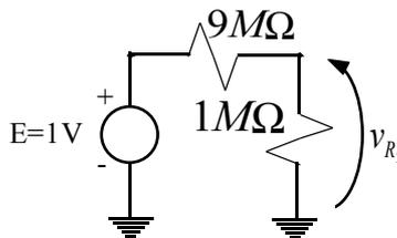
E quindi possiamo calcolare la tensione sul resistore da  $1 \text{ M}\Omega$  sfruttando la regola del partitore di tensione; si avrà quindi:
