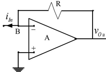
Per ricavare la resistenza da utilizzare ci mettiamo inizialmente nel caso ideale nel quale A tende all'infinito e sfruttiamo la relazione (1) nella quale si utilizza il segno positivo invece che quello negativo perché la corrente ha verso opposto rispetto al caso che abbiamo analizzato precedentemente; si avrà quindi:
