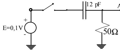
e si valuti l'andamento della tensione al nodo A sapendo che al tempo zero l'interruttore viene chiuso e che il condensatore era inizialmente scarico.
