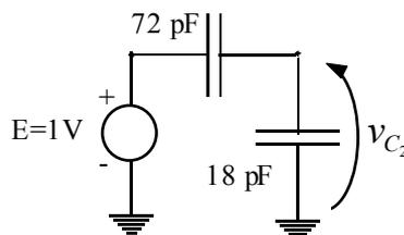
In questo caso la tensione che dobbiamo calcolare è la tensione sul condensatore da  $18 \text{ pF}$  e quindi possiamo usare una formula analoga al partitore di tensione che sarà la seguente:
