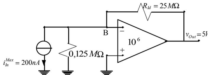
Sfruttiamo dunque la relazione (2) per ricavare l'impedenza di ingresso (ricordando ancora di utilizzare il segno positivo invece che quello negativo):
