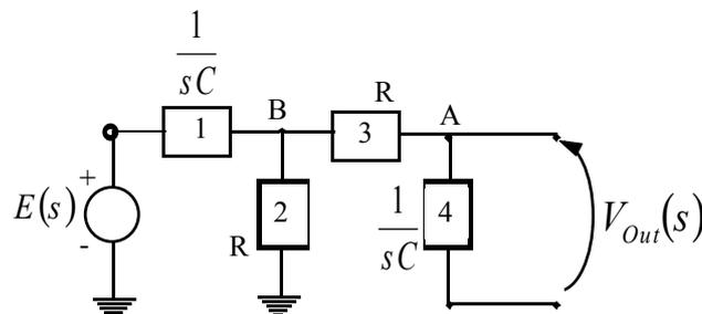
Notiamo ora che, per la legge di Kirchhoff alle maglie, la tensione di uscita (che da ora in poi indicheremo semplicemente con  $V$ ) equivale alla caduta di tensione sull'impedenza numero 4, ovvero:
