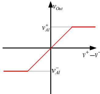
Per valutare i limiti dell'ingresso all'interno dei quali si può avere andamento lineare dell'amplificatore si deve conoscere il valore numerico della tensione di alimentazione e del coefficiente di amplificazione  $A$ ; utilizzando i due seguenti valori piuttosto ragionevoli:
