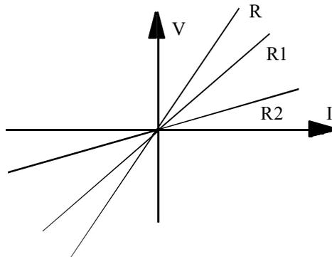
Si osservi come la resistenza equivalente di due resistori collegati in serie è maggiore delle singole resistenze dei due resistori componenti. Il metodo di somma che sfrutta le caratteristiche può essere applicato a qualunque tipo di bipolo, non solo ai bipoli resistivi. Vediamo ora il secondo tipo di collegamento tra due bipoli: il collegamento in parallelo.
