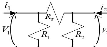
Anche in questo caso i resistori sono collegati in una configurazione mai vista, detta configurazione  $\pi$  (o anche configurazione a triangolo).
