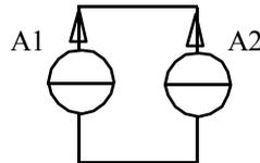
dove le correnti generate dai due generatori sono diverse. Se applichiamo la LKC ad un nodo qualunque di questo circuito otterremo la seguente relazione:
