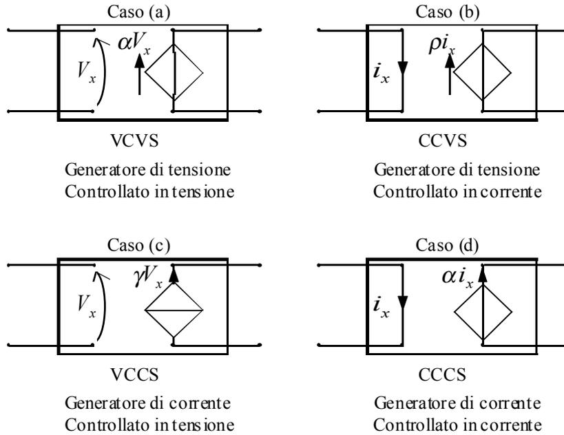
Le grandezze  $\rho$  e  $\gamma$  prendono rispettivamente il nome di transresistenza e di transconduttanza. Cerchiamo ora una rappresentazione matriciale per il generatore pilotato del caso (a); un'analisi della struttura ci porta innanzitutto al seguente sistema:
