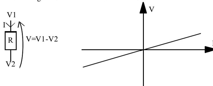
L'andamento della caratteristica permette di comprendere per quale motivo un bipolo di questo tipo si chiama lineare. Attacchiamo, ora, al bipolo, una batteria. Otterremo allora un circuito come quello rappresentato qui di seguito. Nella figura viene anche rappresentata la caratteristica della batteria (supponendo che si tratti di una batteria da 12V):
