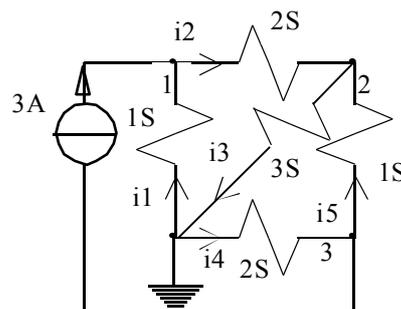
E' importante specificare che le tensioni relative ai vari bipoli, che in figura non sono state rappresentate per una questione di spazio, sono intese prese con la convenzione degli utilizzatori e quindi sempre controverse rispetto alle correnti che, invece, sono rappresentate nello schema. Applichiamo dunque la LKC ai nodi 1, 2 e 3 del circuito ottenendo le tre seguenti relazioni:
