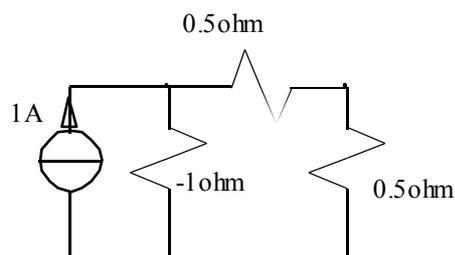
osserviamo che i due resistori da  $0,5\Omega$  sono connessi in serie, questo significa che un circuito del tutto analogo a quello disegnato è il seguente:
