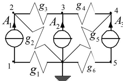
Sfruttiamo il metodo ottico già citato che ci permette di compilare molto in fretta la matrice dei coefficienti (somma delle conduttanze afferenti al nodo sulla diagonale e conduttanze di ramo cambiate di segno fuori dalla diagonale) e otteniamo:
