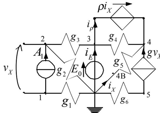
Applichiamo dunque l'NA a tale circuito e aggiungiamo le tre seguenti equazioni che tengono conto dei tre generatore di tensione che dobbiamo considerare sul circuito:
