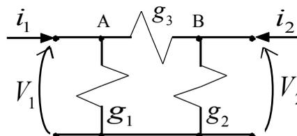
Per quanto riguarda il doppio bipolo di figura (1): si osservi che, applicando una LKC al nodo A si ricava la corrente che attraversa il resistore centrale:
