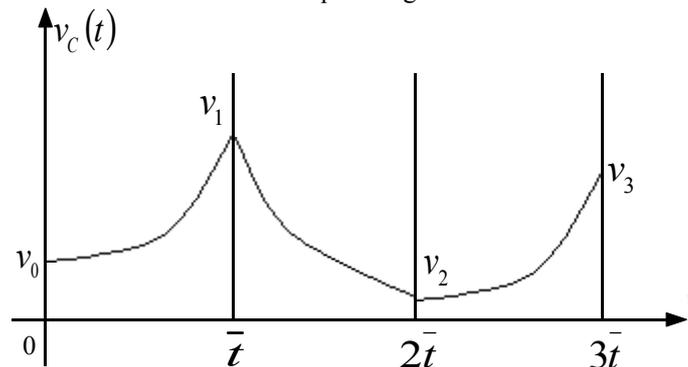
Per quanto riguarda, invece, il grafico della corrente, osserviamo che, anche senza fare i conti, partendo dal grafico della tensione e ricordando che la corrente è legata alla derivata della tensione, possiamo in generale ricavare qualitativamente l'andamento del grafico della corrente semplicemente osservando la pendenza del grafico della tensione.
