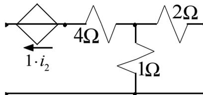
Per verificare che il generatore pilotato sia stato inserito in maniera corretta (soprattutto per quanto riguarda il segno della tensione generata) si applicano due LKV alle due maglie del doppio bipolo e si deve tornare ad avere la coppia di equazioni che si avrebbe avuto utilizzando la matrice originaria. In effetti, nel nostro caso si ottiene:
