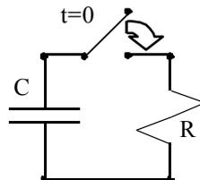
Il nuovo simbolo introdotto rappresenta un interruttore che si chiude all'istante  $t=0$  permettendo alla corrente di iniziare a fluire e al condensatore di scaricarsi. Ricordiamo ora la relazione caratteristica di un condensatore, combiniamola con il risultato trovato per l'equazione differenziale che stiamo analizzando e troviamo la corrente che fluisce nel condensatore:
