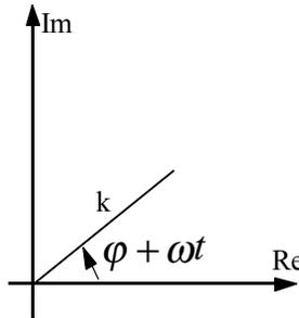
La sinusoidale non è altro che la proiezione del fasore in movimento sull'asse delle ascisse. Si osservi che quando ci sono più fasori che hanno tutti la stessa frequenza, possiamo considerare fermo il sistema. Vediamo ora di applicare il discorso sui fasori ai circuiti. Supponiamo di avere il seguente circuito generico:
