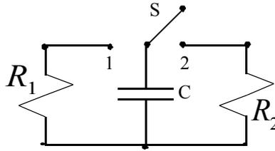
E' richiesto di graficare l'andamento della tensione e della corrente sul condensatore sapendo che il dato iniziale è:
