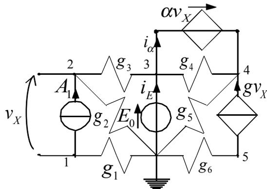
In questo caso è stato aggiunto, rispetto all'esercizio precedente, un ulteriore generatore di tensione e quindi si dovrà aggiungere una ulteriore riga ed una ulteriore colonna (si noti, inoltre, la variazione del verso della corrente che attraversa il generatore indipendente di tensione); si introduce dunque, come incognita, la corrente che passa nel generatore di tensione pilotato e, come equazione, quella che esprime il legame tra questo generatore e la rete nella quale è inserito, ovvero:
