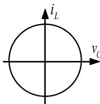
Dimostriamo ora come un sistema di questo tipo conservi l'energia: l'energia immagazzinata dal condensatore è data dalla relazione:
