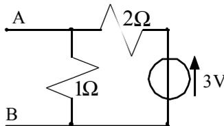
Per valutare l'equivalente Thevenin devo valutare, innanzitutto, la resistenza equivalente, per far questo spengo il generatore di tensione ottenendo il bipolo di figura (a). A questo punto si nota che i due resistori sono collegati in parallelo – figura (b)-, posso dunque ridurli ad uno solo ottenendo il bipolo di figura (c):
