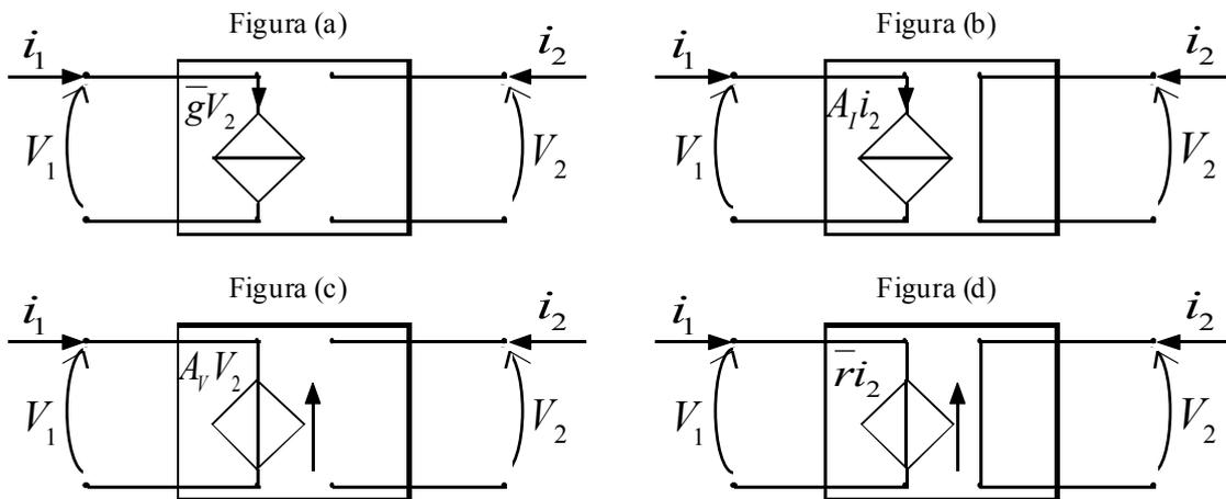
Consideriamo dunque, per primo, il generatore di corrente pilotato in tensione (rappresentato in figura (a)). Le due equazioni caratteristiche di tale doppio bipolo sono raccolte nel seguente sistema:
