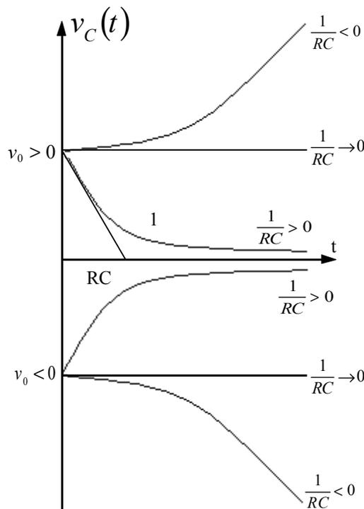
Dimostriamo analiticamente che la tangente in  $t=0$  alla linea 1 incontra l'asse della ascisse nel punto  $t=RC$ . Se deriviamo la soluzione dell'equazione differenziale otteniamo, infatti:
