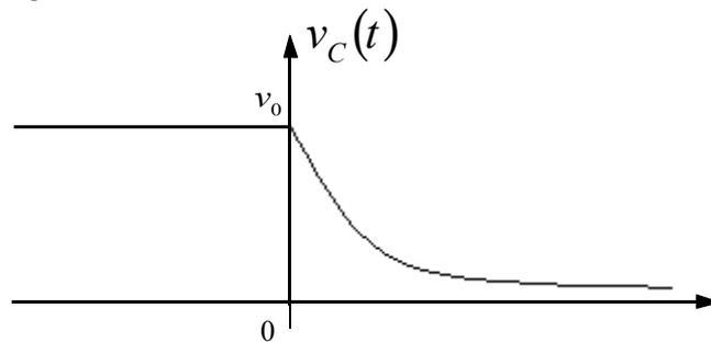
L'analisi di tale grafico ci suggerisce la seguente interpretazione: fino al tempo  $t=0$  avevamo un condensatore carico isolato, al tempo  $t=0$  tale condensatore è stato posto in contatto con un resistore, ha iniziato a circolare corrente e il condensatore si è scaricato. Dal punto di vista circuitale ciò significa avere un circuito del tipo seguente:
