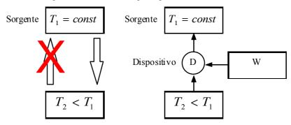
Le trasformazioni schematizzate nella parte destra dei due disegni sono compatibili con il secondo principio e sono di solito operate ciclicamente.
