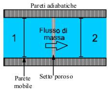
Questo sistema non evolve per stati di equilibrio ma evolve in quanto c'è squilibrio finito tra i due sistemi. Data l'adiabaticità delle pareti la massa fluisce dal sottosistema 1 al sottosistema 2, c'è dunque lavoro ma non è scambiato con l'esterno.
