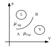
Passando dal punto A al punto B e supponendo che la trasformazione avvenga sulla linea che divide lo stato di liquido dallo stato di vapore, si avrà una variazione di temperatura dT alla quale sarà associata una variazione di pressione dp. Per quanto riguarda il potenziale, passando dal punto A al punto B si dovrà avere:
