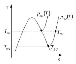
L'umidità si può calcolare con diversi metodi sfruttando i dati che appaiono in questo grafico; vediamone alcuni. Il primo metodo che vediamo si basa sulla determinazione della temperatura di rugiada e prende il nome di principio di misurazione di Dew Point. La configurazione sperimentale relativa a tale metodo è rappresentata nella figura seguente:
