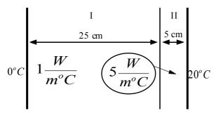
Ricordiamo innanzitutto quanto detto a proposito della resistività termica nelle configurazioni monodimensionali come questa e calcoliamo la resistività termica complessiva del sistema nel modo seguente:
