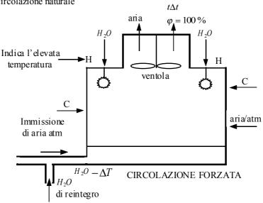
Consideriamo ora une centrale termoelettrica di potenza 600 MW con una portata di massa di 22084 kg/s. L'acqua entra nel condensatore alla temperatura di 40°C mentre l'aria vi entra a 27°C con una umidità relativa del 40%. L'aria esce ad una temperatura di 35°C. Calcolare la portata dell'acqua di reintegro
