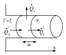
Il primo membro dell'ultima relazione scritta deriva ovviamente dalla conduzione mentre il secondo membro deriva dalla convezione e proprio nel secondo membro vediamo apparire la temperatura del fluido. Riscriviamo dunque l'ultima relazione nel modo seguente:
